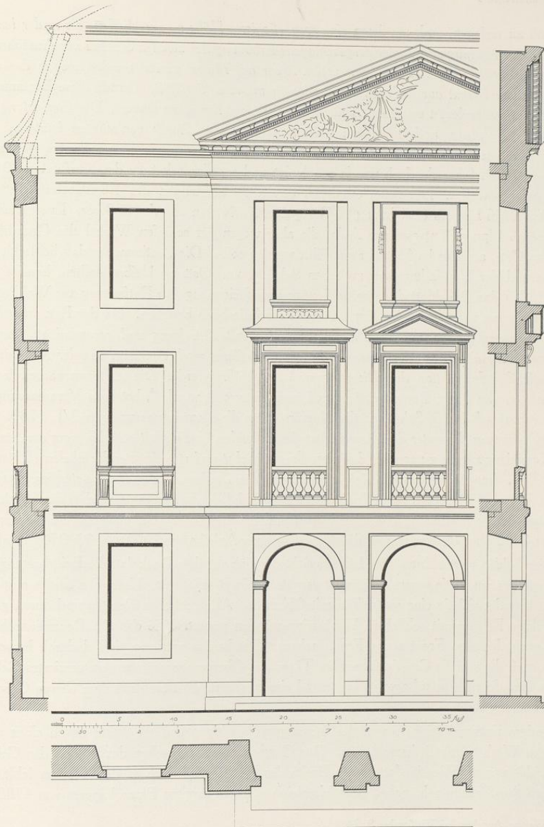
Abb. 1337. Aufriß und Schnitte der Mitte der Südfront Pause der Bauzeichnung Lippers Nr. 905. Maßstab 1 : 100
