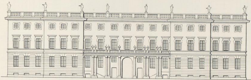
Abb. 999. Aufriß der Rückfront des Nordkirchener Hofes Entwurf von G. L. Pictorius, Zeichnung Nr. 698, Pause. Maßstab etwa 1 : 450
