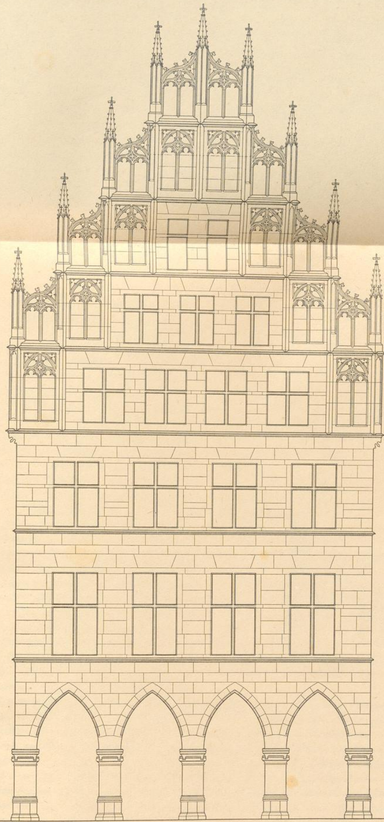
Abb. 656. Rekonstruktion der Westfront des Hauses Prinzpalmarkt 8 Maßstab 1 : 100
