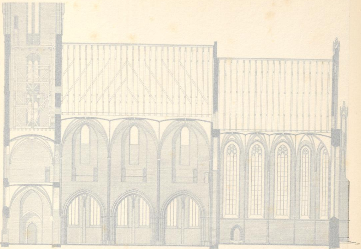
LÄNGENDURCHSCHNITT MIT ANDEUTUNG DES URSPRÜNGLICHEN BUNTEN ZIEGELWERKS.
