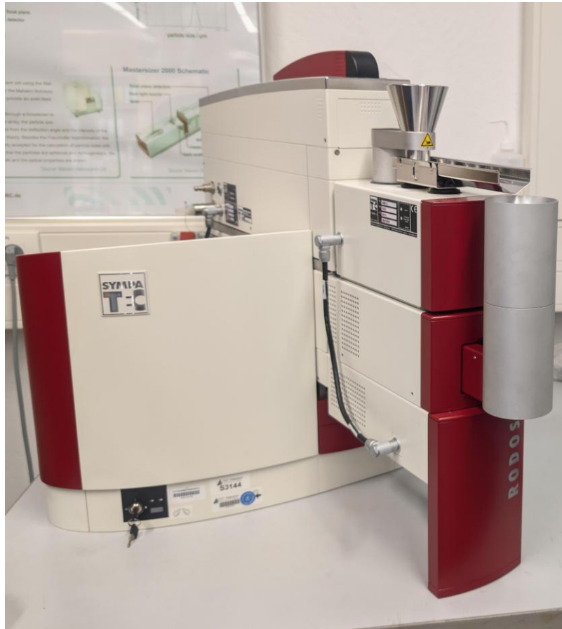
Abbildung 5-20: Verwendetes QICPIC in der Konfiguration mit dem RODOS/L und der Dosiereinheit VIBRI/L
