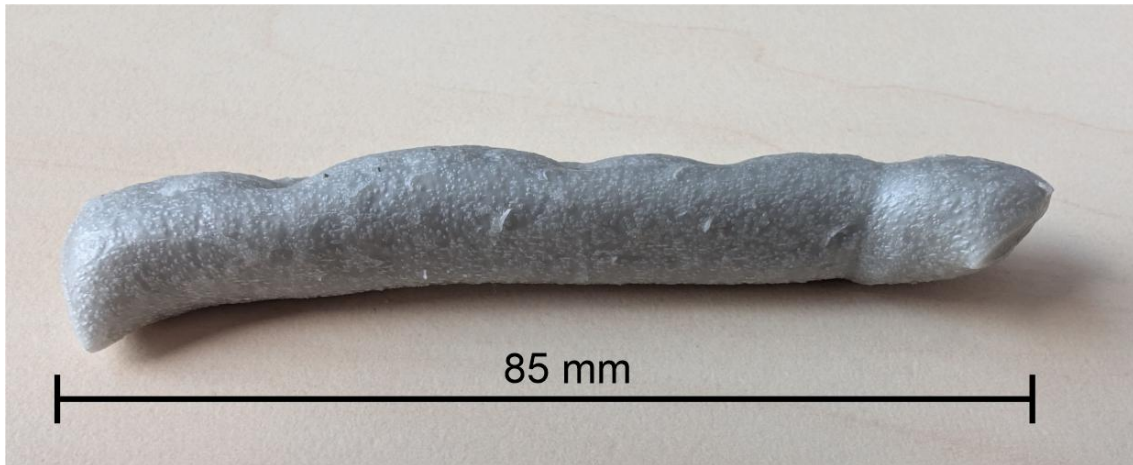
Abbildung 5-18: Probengeometrie bei dem Material 505P
