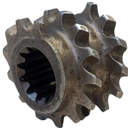
Abbildung 2-6: Darstellung von einem Zahnmischelement (ZME)
