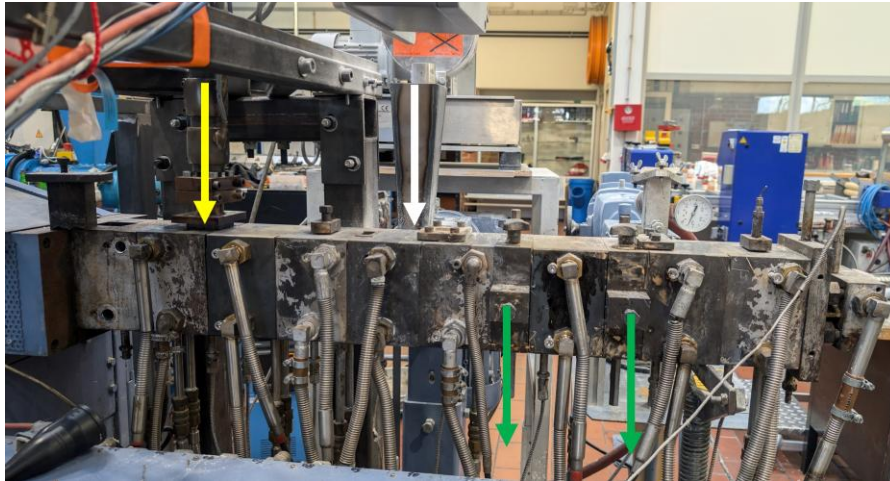
Abbildung 5-11: Zylindergehäuseanordnung der ZSK25 mit der Schmelzeleitung (gelb), Seitendosierung (weiß) und den Probeentnahmeplatten (grün).
