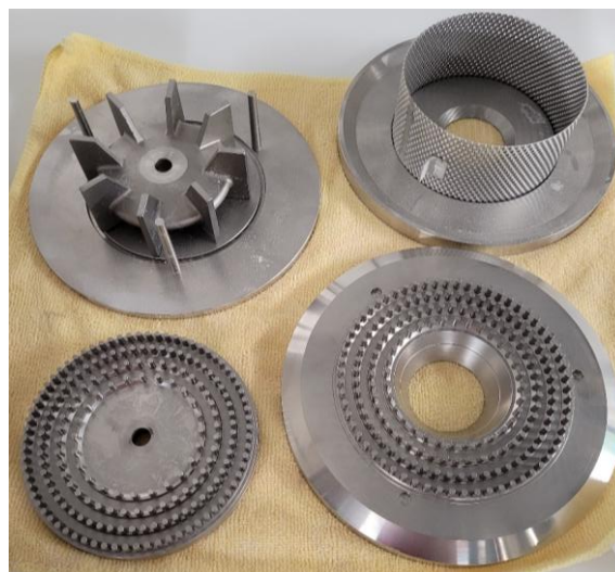
Abbildung 36: Unterschiedliche Mahlwerkeinsätze der Kaltmahanlage - Fächerschläger und Stiftmühle [Wie23]
