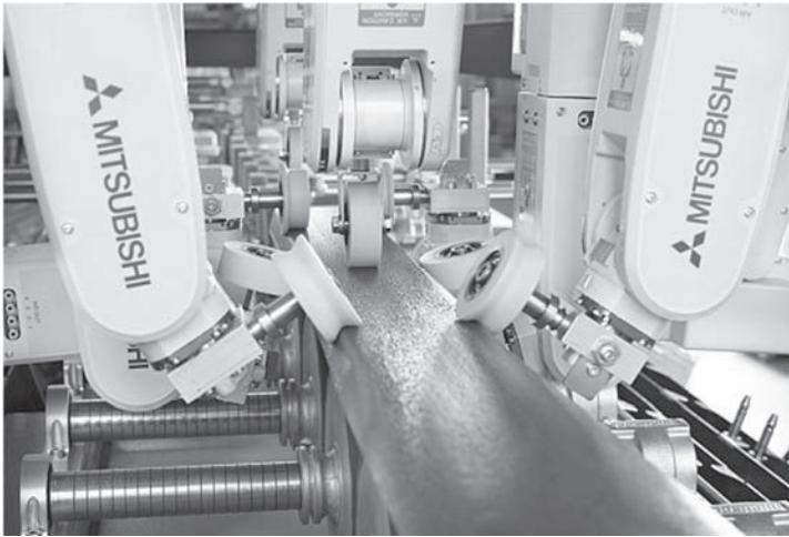
Bild 1: Eine Anordnung mehrerer Roboterarme ermöglicht es, die Rollenkonfiguration einer Profilmantelungsanlage automatisiert anzupassen (entnommen aus [I15-ol])
