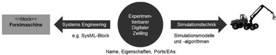
Bild 3: Die Verbindung zwischen MBSE und Simulationstechnik erfolgt über EDZe
