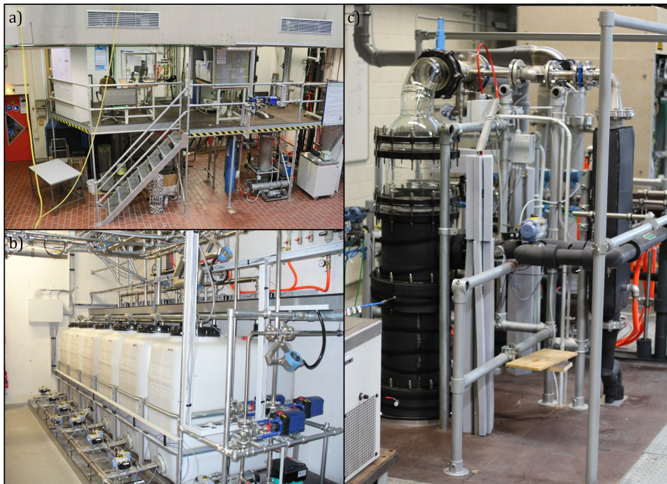
Abbildung 3.1: Fotos der Technikumsanlage: Überblick über den mittleren Teil der Anlage mit Steuerung, Gaschromatograph und Kolonnen (a); Vorratsbehälter für das Lösungsmittel im Keller unterhalb der Anlage (b); Oberer Bereich der Anlage mit Kolonnenköpfen (c).
