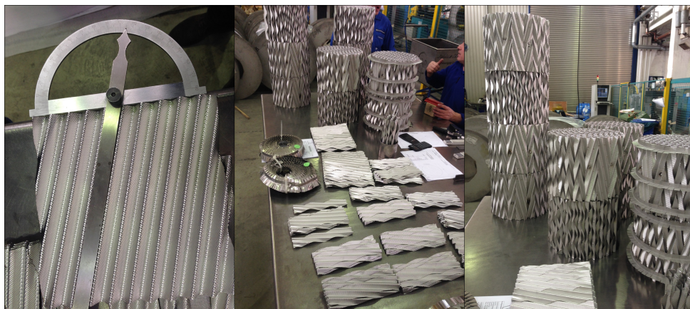
Abbildung 4.9: Fotos eines Schrittes aus dem Produktionsprozess der B1-250.75 bei der Julius Montz GmbH.
