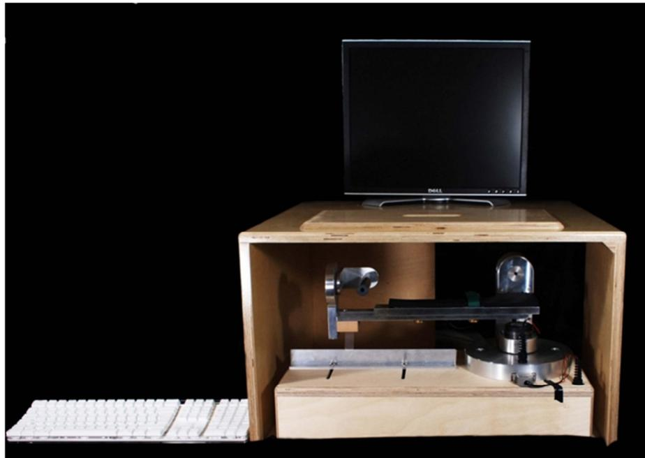
Abb. 20. Versuchsaufbau mit Unterarmhebel auf Holzkonsole, visueller Maskierung, Monitor und Tastatur (modifiziert nach Agethen & Jasarovski, 2011, S. 89).
