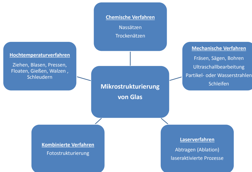
Abbildung 6.54: Verfahren zur Mikrostrukturierung von Glas
