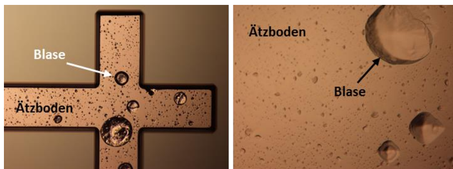
Abbildung 4.16: Morphologie einer {001}-Oberflche nach tzung auf GM0 mit TMAH (25 wt.%) und 0.3 vol.% Tensid 3 bei 70°C. Die erhhte Anzahl der blasenfrmigen Antzungen der Siliziumoberflche sind auf die Adhsion von Tensidagglomeraten zurckzufhren
