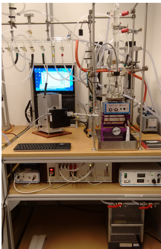
Abb. 47: Katalyse-Anlage für die photokatalytische Wasserspaltung.
