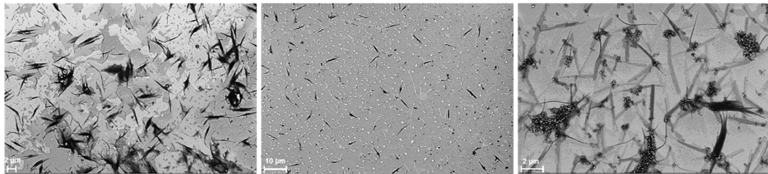
Abbildung 47 Nadelförmige Graphenstruktur unter dem REM
