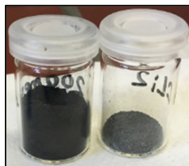
Abbildung 72 Vergleich des Graphitpulvers vor (links) und nach Lithium-Interkalation-Expandierung (rechts)
