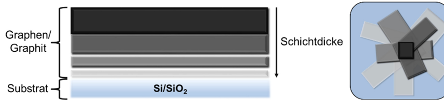
Abbildung 51 Schematische Darstellung der häufig vorkommenden Stapelreihfolge des abgeschiedenen Graphens
