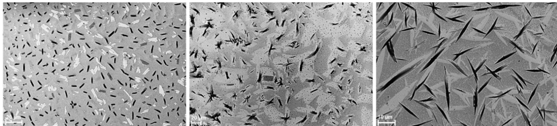
Abbildung 40 REM-Aufnahme des hergestellten Graphens aus einem MEK/Wasser-Gemisch mit einem Mischungsverhältnis von 99,3/0,7
