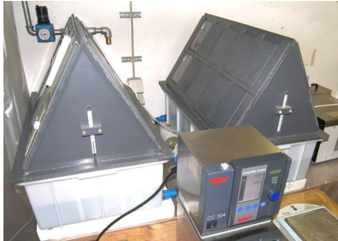
Abb. 6.3: Prüfkammer für den Kondenswassertest. Die Proben sind mit der Beschichtung nach innen auf dem „Dach“ aufgelegt.
