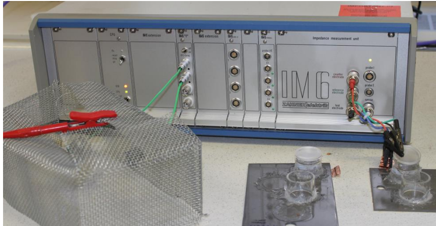
Abb. 6.4: Prüfanordnung zur EIS-Messung
