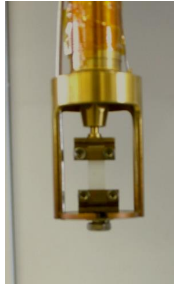
Abb. 6.6: Aufbau des Zugmodus einer DMA; eingespannter freier Beschichtungsfilm.
