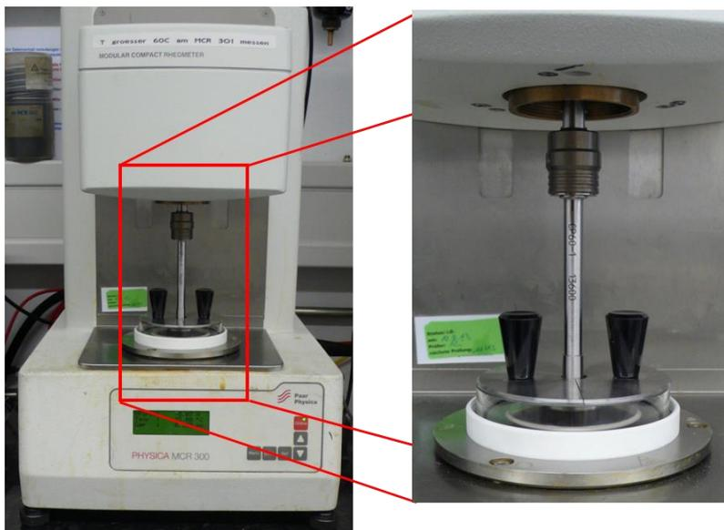
Abbildung 28: Rheomat MCR 300 mit Lösemittelfalle, Detailansicht rechts
