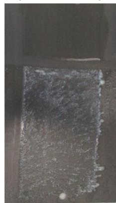
Abbildung 121: Zusammenfassende Darstellung des Filmangriffs der Copolymerisat-freien Systeme durch VE-Wasser
