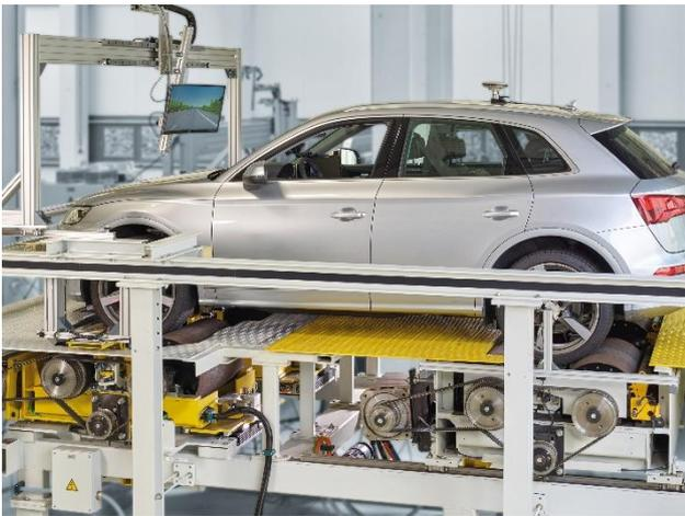
Abb. 10: Lenkbare Funktionsprüfstand „x-road curve“ mit Fahrzeug und Bildschirm
