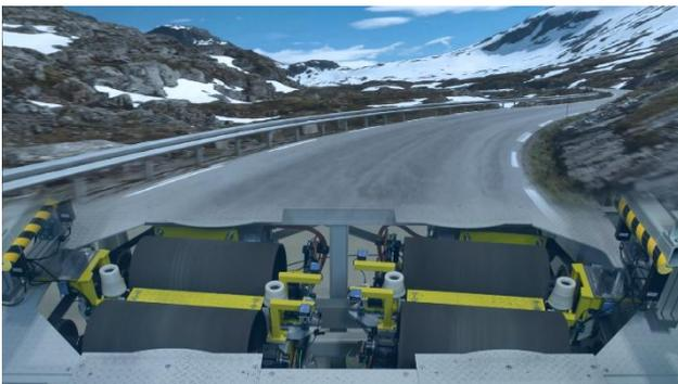
Zum ersten Mal ist es gelungen, einen lenkbaren Funktionsprüfstand zu entwickeln, auf dem nicht nur die Funktionalität im Geradeauslauf, sondern auch bei unterschiedlichen Lenkwinkeln im Bereich von  $\pm 10^\circ$  und bei Geschwindigkeiten bis zu 130 km/h geprüft werden kann.
