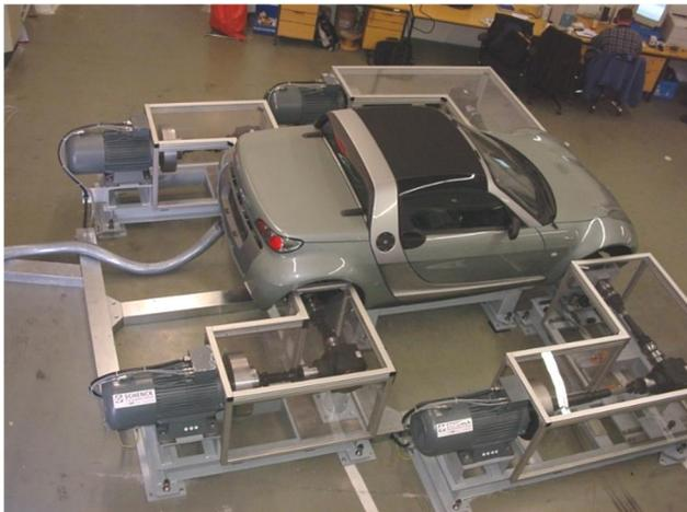
Abb. 1a: VeHiL Funktionsprüfstand mit Fahrzeug im EU-Projekt SPARC
