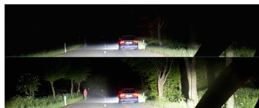
**Abbildung 1** Vergrößerung des Wahrnehmungsbereiches (der Fußgänger ist zu erkennen) durch blendfreies Fernlicht (unten) im Vergleich zu konventionellem Abblendlicht (oben) [2].
