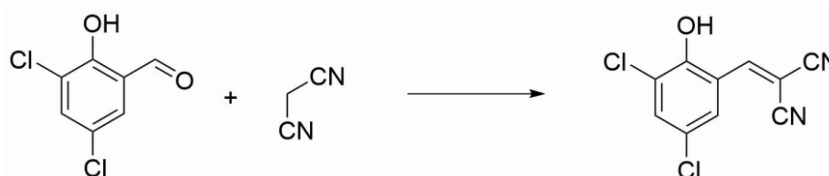
Abbildung 94: Knoevenagel-Reaktion von 3,5DC2HBA und MDN.
