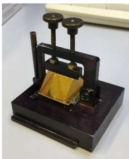
Abbildung 64: Bild von der vollständig zusammengebauten SPR Probenhalterung (links); Bild von der in das Goniometer eingebauten Probenhalterung (rechts).
