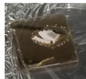
Abbildung 102: SPR Träger mit einem getrockneten Gel, welches während der Trocknung eingemischt ist.
