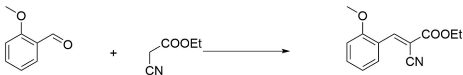
Abbildung 53: Knoevenagel-Reaktion von 2-Methoxybenzaldehyd mit Cyanoessigsäureethylester.
