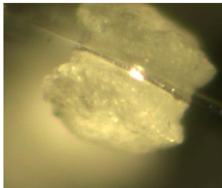
Abbildung 114: Lichtmikroskopische Aufnahme eines Geldots hergestellt auf einem Objektträger nach 6 h Quellzeit in Wasser und anschließender Gefriertrocknung.
