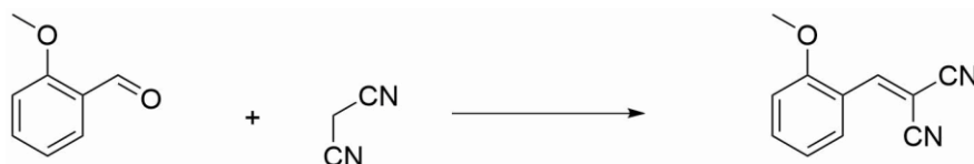
Abbildung 45: Knoevenagel-Reaktion von ortho-Anisaldehyd (oAnis) mit Malononitril.
