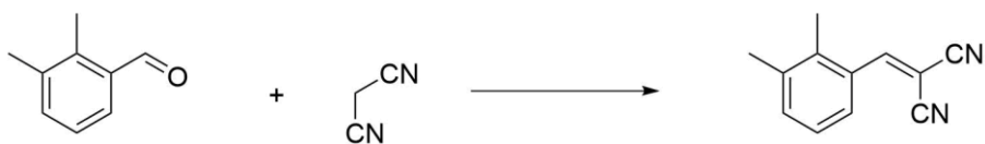
Abbildung 43: Knoevenagel-Reaktion von 2,3-Dimethylbenzaldehyd (2,3DMBA) mit Malononitril.
