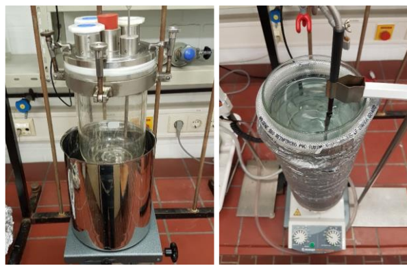
Abbildung 7.2: Reaktoren Auswahl bei der hydrothermalen (links) bzw. thermalen (rechts) Reaktorführung
