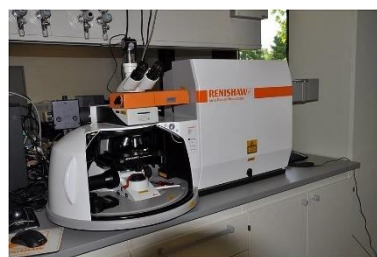
Abbildung 4.9: Kombination aus Renishaw InVia Raman Spektroskop und Leica DM 2500 M Mikroskop
