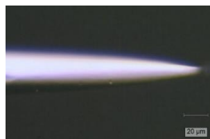
Abbildung 4.4: Elektrolytisch hergestellte SKP-Sonde (Cr-Ni-Draht) mit einem Durchmesser von 25 \mu\text{m} vor der Abflachung mittels Ion-Polisher
