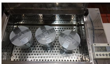
Abbildung 7.1: Hydrothermale ZnO-Synthese in PP-Behälter in Vorversuchen
