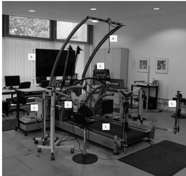
Abbildung 35: Aufbau der Messtechnik im Institut für Biomechanik der Klinik Lindenplatz; 1.) Laufband der Firma h/p/cosmos sports & medical GmbH mit integrierter Druckmessplatte (zebris FDM); 2.) 3D –Bewegungsanalysesystem CMS-HS der Firma zebris Medical GmbH; 3.) abgedeckte Laufbandsteuerung; 4.) Sicherungsseil 5.) Robowalk System der Firma h/p/cosmos für das taktile Feedbacktraining, 6.) Bildschirm für das virtuelle Feedbacktraining
