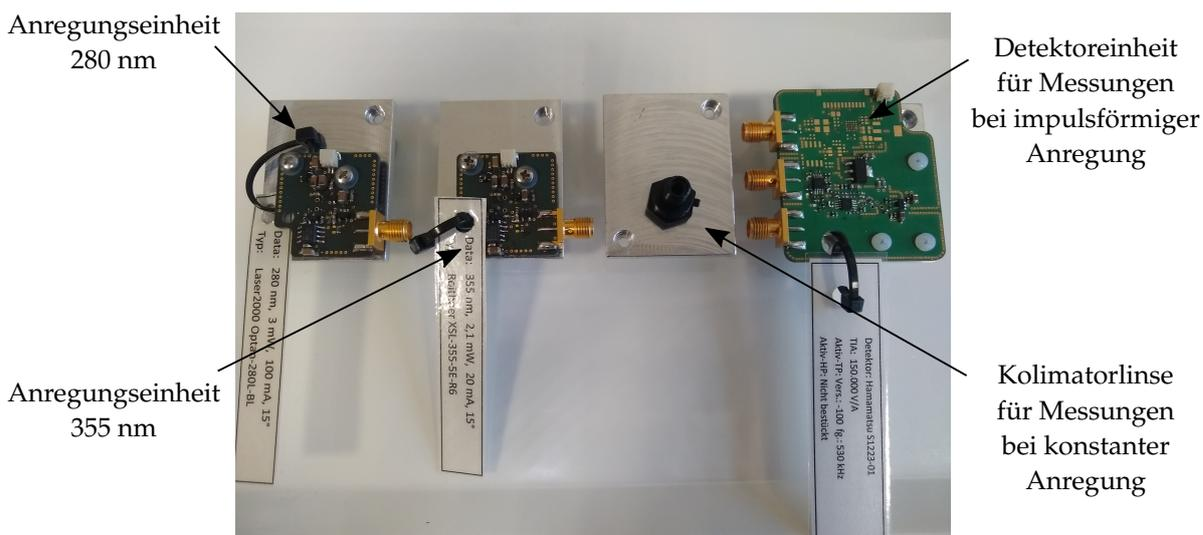
Abbildung A.17.6: Einsätze für den Küvettenhalter - Rückseite
