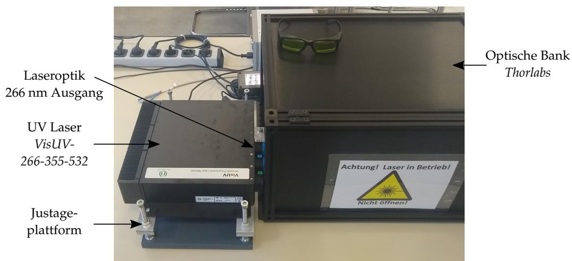
Abbildung A.17.9: Messaufbau zur zeitaufgelösten Einzelphotonenzählung - Vorderseite 1
