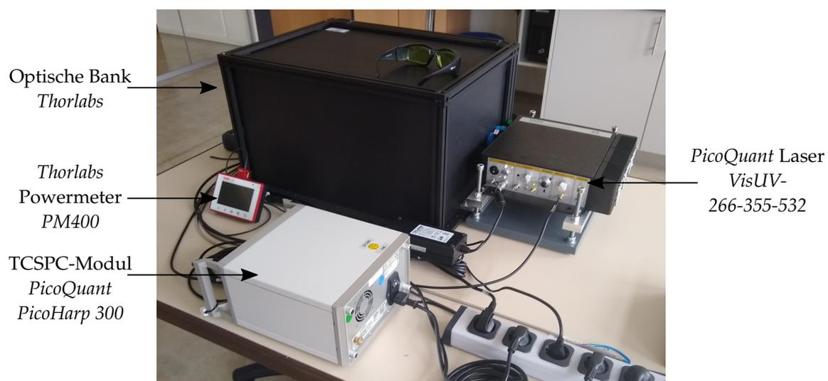
**Abbildung A.17.11:** Messaufbau zur zeitaufgelösten Einzelphotonenzählung - Rückseite
