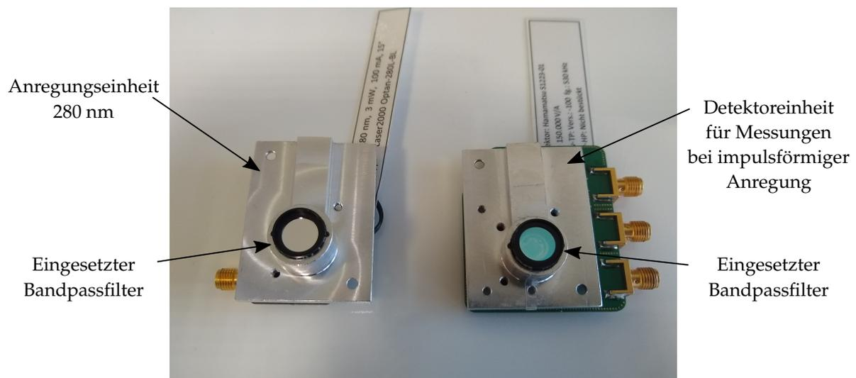
Abbildung A.17.8: Einsätze für den Küvettenhalter mit eingesetzten Filter
