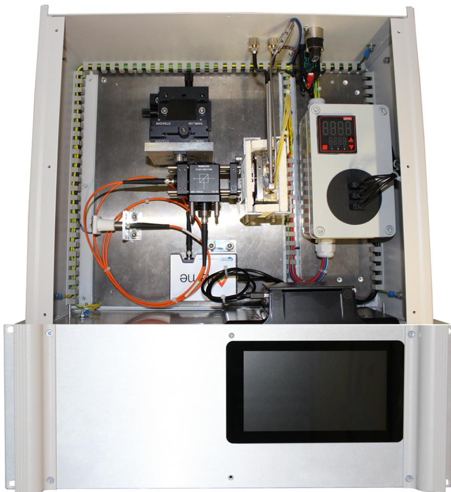
Abbildung 112: Messaufbau; links: optischer Aufbau mit Lichtquelle, Lichtleiter, Strahlenteiler, Probenkammer und Spektrometer, rechts: Regelelektronik zur Steuerung der Temperatur, vorne: Display zur grafischen Ausgabe der gemessenen Spektren
