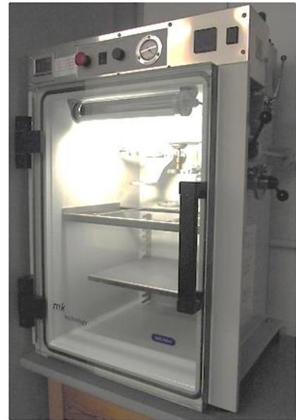
**Abbildung 20.** Manuelle Vakuumgießanlage MK Mini [FHB21].
