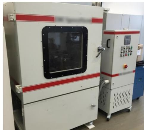
**Abbildung 4:** Foto einer Rapid-Injektor-Anlage bestehend aus Prozesskammer (links) und Dosieranlage (rechts).
