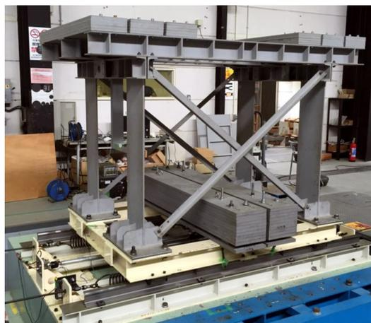
Bild 3-5: Rütteltisch für Strukturtests [ZPT<sup>+</sup> 17]
