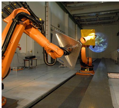
Bild 3-7: Prüfumgebung für die HiL-Simulation zur Nachbildung eines *Rendezvous and Docking* Manövers [MFB12]
