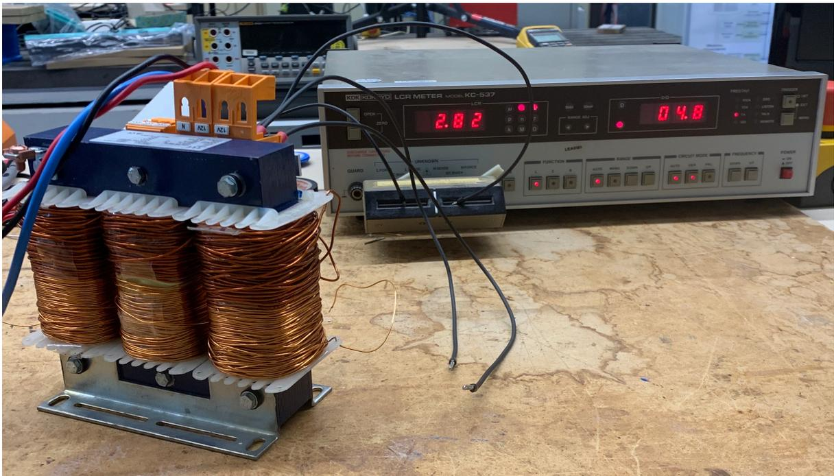
Abbildung 5.2.: Induktivitätsmessgerät mit Dreieck-Dreieck-Stern Transformator, hier bei der Messung der sekundären Dreieckswicklung, des rechten Schenkels
