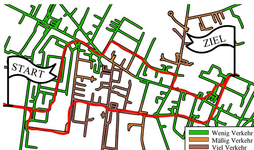
Abbildung 2-9: Beispiel für intelligentes Routing zwischen Start und Ziel. Die untere Route stellt den kürzesten Weg ohne Rücksicht auf das Verkehrsaufkommen dar. Die obere Route ist länger, berücksichtigt jedoch das Verkehrsaufkommen und entschärft die Verkehrsbelastung
