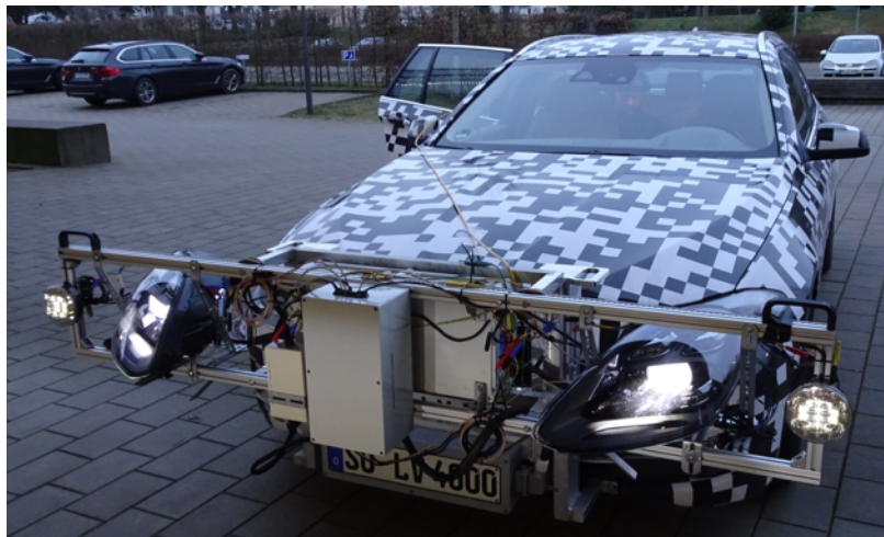
Bild 1-1: Rack zur Erprobung von Scheinwerfer-Prototypen montiert an einem Testfahrzeug der HELLA.
