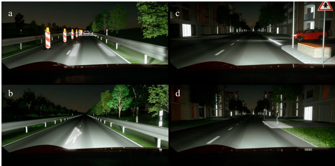
Bild 3-17: HD-Lichtfunktionen zur Vermeidung der häufigsten nächtlichen Unfalltypen nach Roth et al. [RTH + 19].
