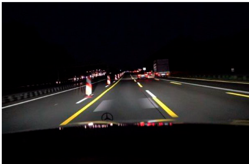
Bild 3-20: Construction Zone Light (CZL) zur Unterstützung des Fahrers in engen Fahrspuren von Autobahnbaustellen aus [RL19].
