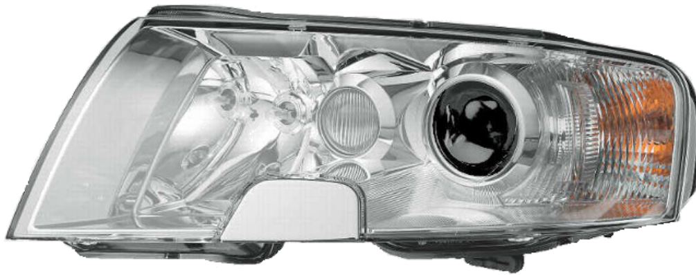
Bild 3-7: Freiflächen-Reflexionssystem für die Abblendlichtfunktion und Super-DE-Projektionssystem für die Fernlichtfunktion im Hauptscheinwerfer eines Skoda Superb [Quelle: HELLA].
