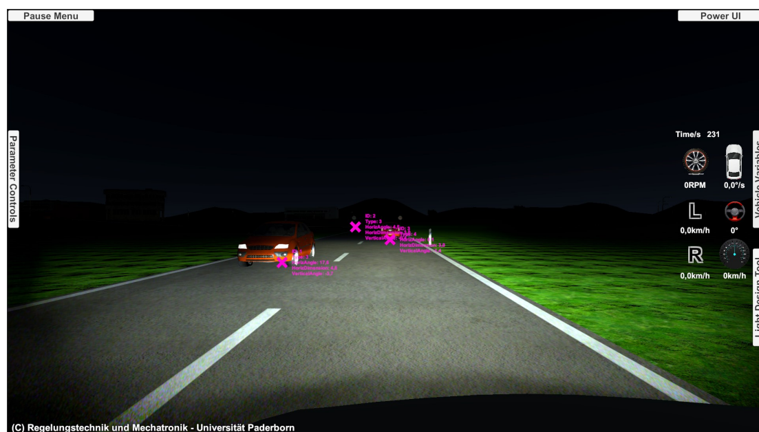
Bild 7-4: Dashboard des Fahrzeugzustands und Visualisierung der Umfelderkennung zur Analyse lichtrelevanter Eingangsgrößen.
