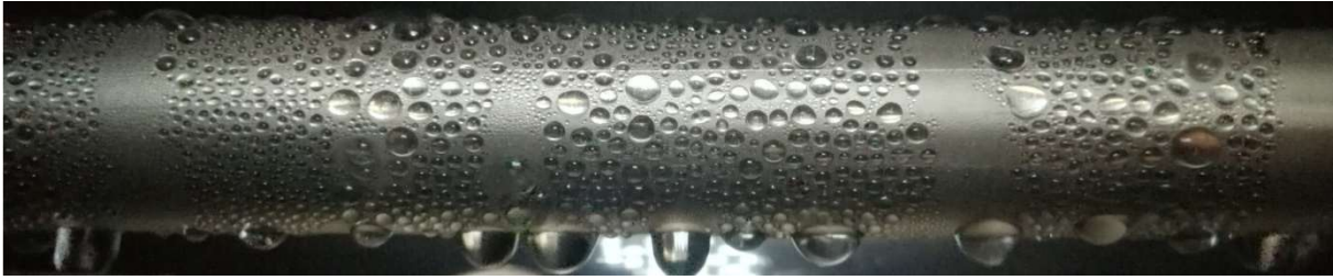
Abbildung 34: PTFE-Beschichtung nach 208 Betriebsstunden.
