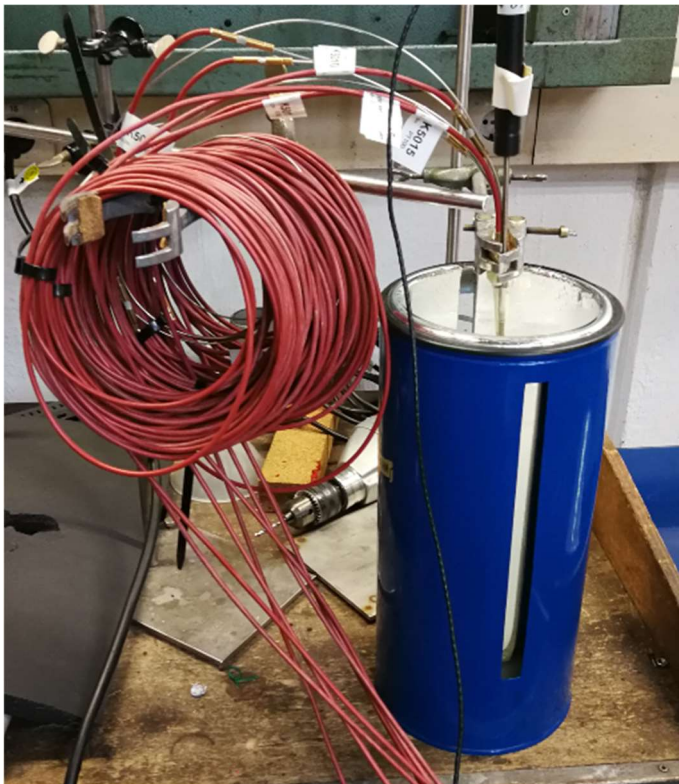
Abbildung 11: Versuchsaufbau zur Nullpunkt-Kalibrierung von Temperatur-Messfühlern.
