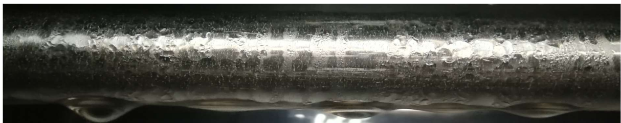
Abbildung 24: Sol-Gel-Beschichtung nach 1 Betriebsstunde.
