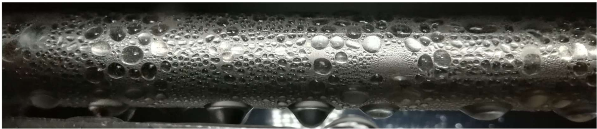
Abbildung 31: PTFE-Beschichtung nach 2 Betriebsstunden.
