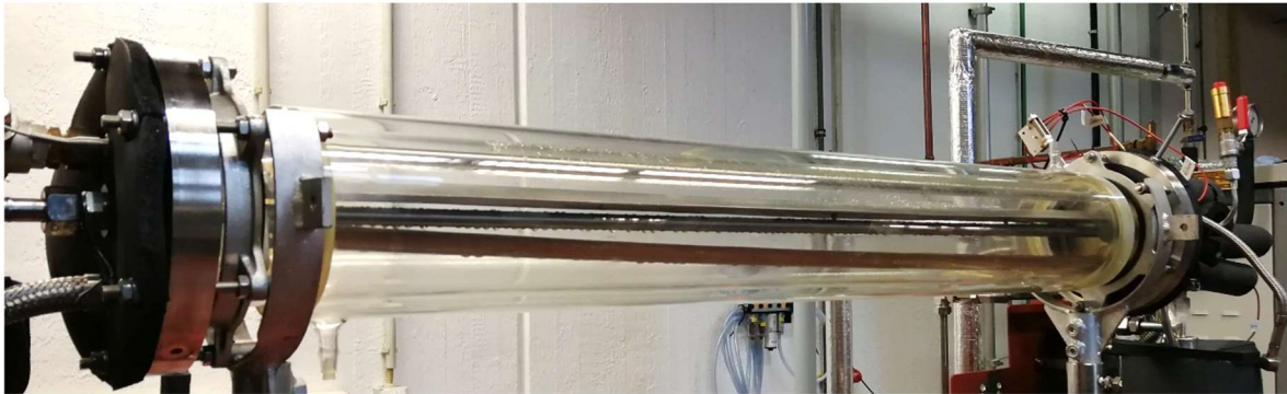
Abbildung 10: Foto des Kondensators der Versuchsanlage aus doppelwandigem Glasrohr.
