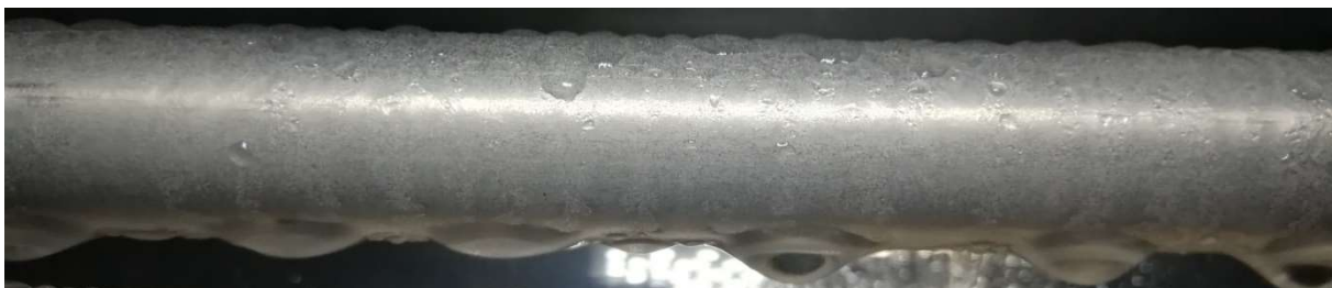
Abbildung 21: PDMS-Beschichtung nach 2 Betriebsstunden.
