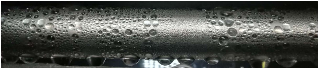
Abbildung 32: PTFE-Beschichtung nach 20 Betriebsstunden.
