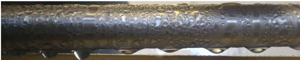
Abbildung 20: PDMS-Beschichtung nach 0 Betriebsstunden.
