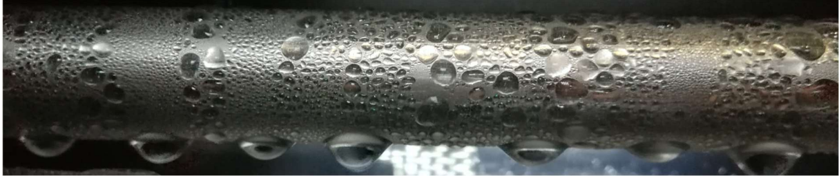
Abbildung 30: PTFE-Beschichtung nach 0 Betriebsstunden.
