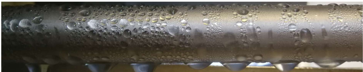
Abbildung 23: Sol-Gel-Beschichtung nach 0 Betriebsstunden.
