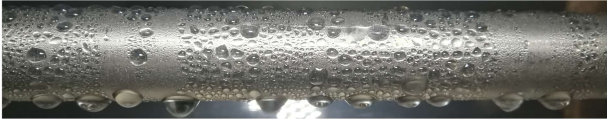
Abbildung 27: Polysilazan-Beschichtung nach 2 Betriebsstunden.
