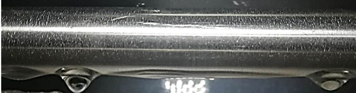
Abbildung 3: Filmkondensation an einem waagrechten Einzelrohr.
