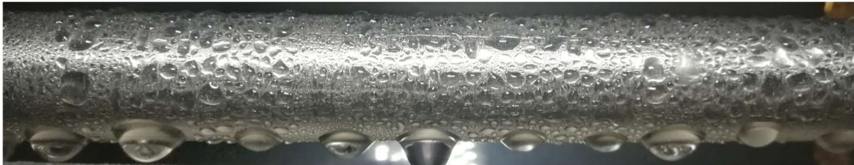
Abbildung 28: Polysilazan-Beschichtung nach 4 Betriebsstunden.
