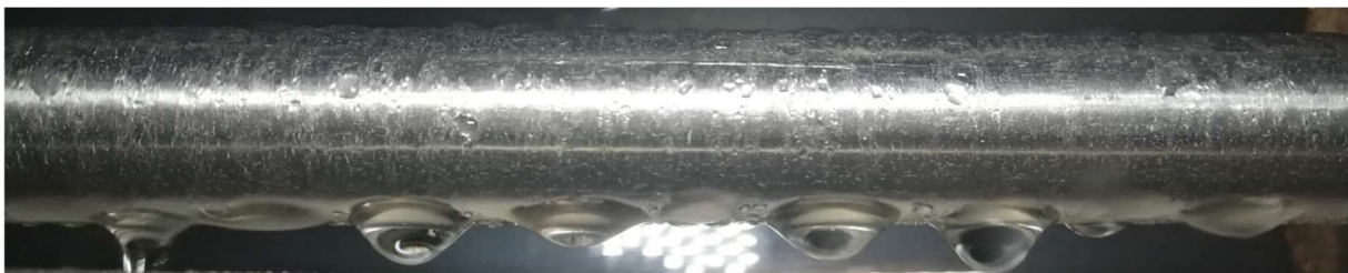
Abbildung 29: Polysilazan-Beschichtung nach 21 Betriebsstunden.
