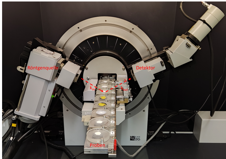
Abbildung 4.5.: Aufbau des genutzten PXRDs. Die Pfeile zeigen schematisch die Wellenvektoren k_{in} und k_{out} .
