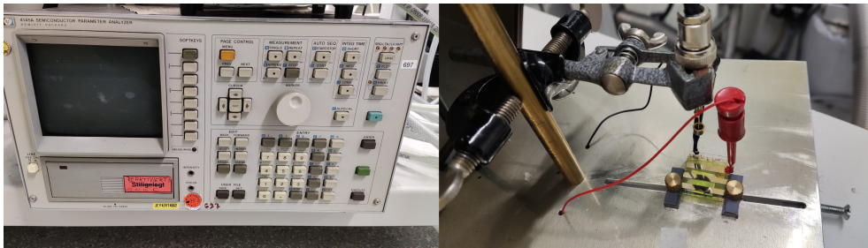
Abbildung 3.12.: Die Messbrücke HP 4145 A Semiconductor Parameter Analyzer (links). Angeschlossene OLED mit der kalibrierten Photodiode (rechts).
