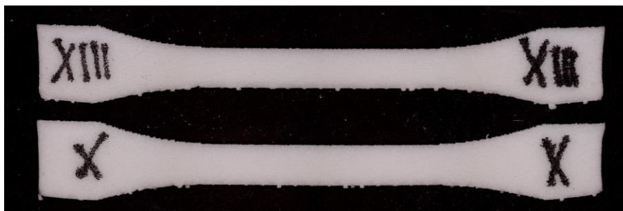
Bild 5-31: Im Schulterbereich deformierte bzw. verzogene Zugprüfkörper in XZY-Orientierung
