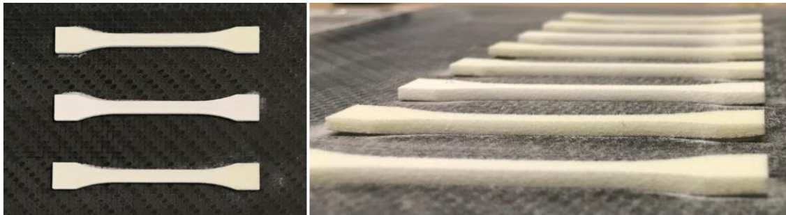
Bild 5-12: Auf der Bauplattform gefertigte Zugstäbe des Typs 1BA (rechts: Leichter Verzug und geringfügige Ablösung von der Bauplattform)
