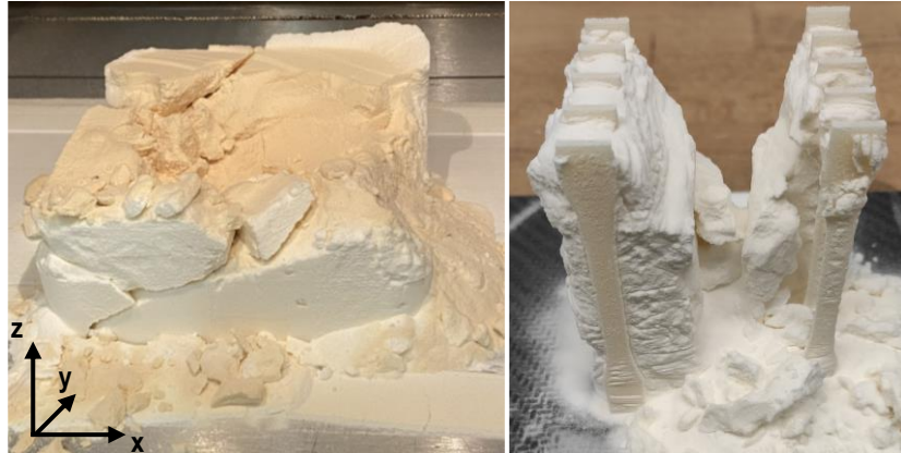
Bild 6-9: Prozessalterung in der AMCM P395 HT bei 202°C im LS (links) und in der EOS P396 bei 150 °C im NTLS (rechts) bei einer Baujobdauer von 8 bzw. 7,5 Stunden
