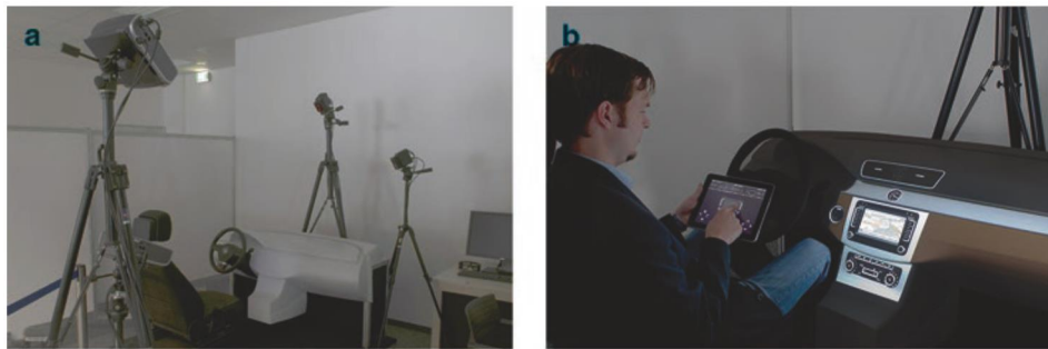
Abbildung 4-29: AR-basierte Validierung verschiedener Fahrzeug-Interieurs unter Einbindung physischer Elemente, Bildausschnitt aus [DKM+19, S. 375]
