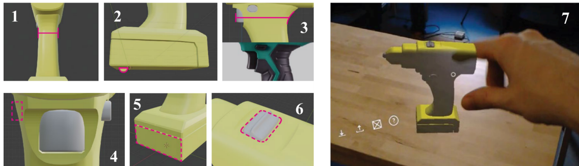
Abbildung A-23: Über einen AR-basierten Prototypen dargestellte Mängel an einem Akkubohrer (1-6) und die Live-Ansicht über eine HoloLens (7)
