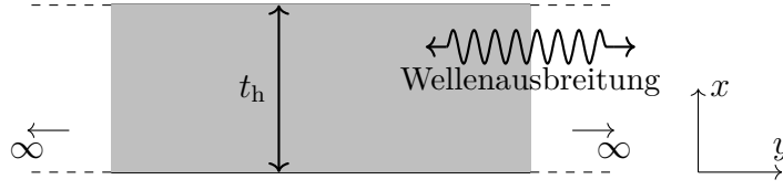
Abbildung 2.4: Querschnitt eines Plattenwellenleiter
