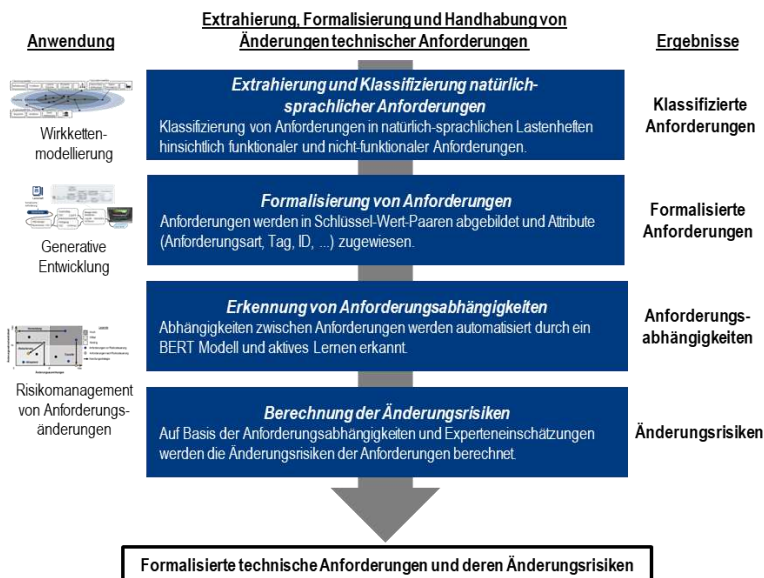
Bild 6-1: Methodik zur Extrahierung, Formalisierung und Handhabung von Änderungen technischer Anforderungen
