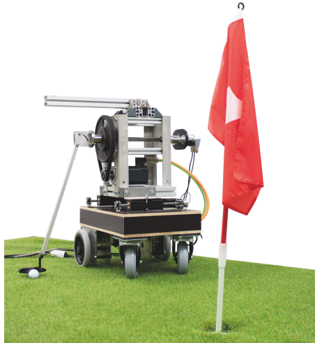
Abbildung 6.1 Golfi ist ein selbstlernender Golfroboter, der in der Lage ist autonom zu putten. Golfi dient als Demonstrator für die Anwendung von datengetriebenen Methoden in der Regelungstechnik.
