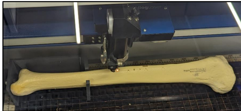
Bild 6-20: Markierung der Schraubpositionen mithilfe eines Flachbettlasers
