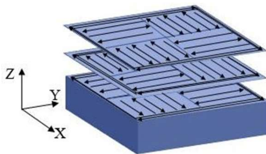
Abbildung 22: Laservektoren und Scanstrategie am Beispiel des Schachmusters [61]
