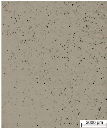
Abbildung 39: Parameterstudie zu FeSi3: a) Helligkeitsvergleich Probe 34, höchste relative Dichte, 99,98 %, b) CT-Analyse Probe 34, relative Dichte 99,99 % c) Helligkeitsvergleich Probe 21, geringste relative Dichte, 98,15 %, d) Helligkeitsvergleich Probe 29, relative Dichte 99,23 %
