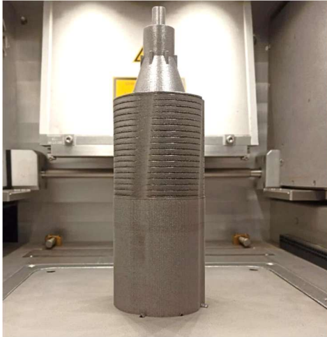
Abbildung 66: Rotordemonstrator nach dem SLM-Verfahren im Bauraum (links) und nach dem Entfernen von der Bauplattform mit entfernten Stützstrukturen (rechts)
