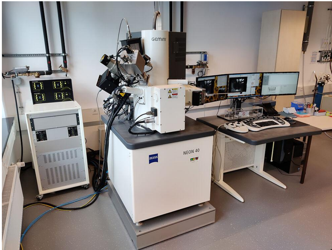
Abbildung 28 Für die Oberflächenanalyse verwendetes Feldemissions-Rasterelektronenmikroskop Neon 40 FE-SEM-Mikroskop (Carl Zeiss SMT AG, Deutschland) an der UPB (Fotographie: Nadine Builtkamp)
