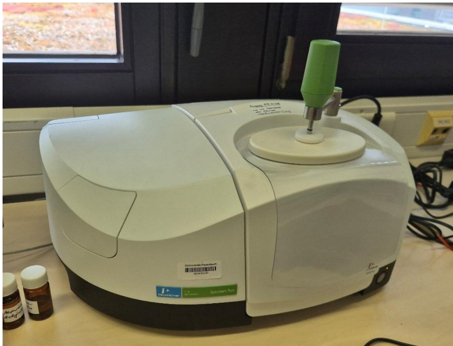
Abbildung 26 Für die ATR-FTIR verwendetes FTIR-Spektrometer Eigene Fotografie des Spectrum two, Perkin Elmer, am TMC
