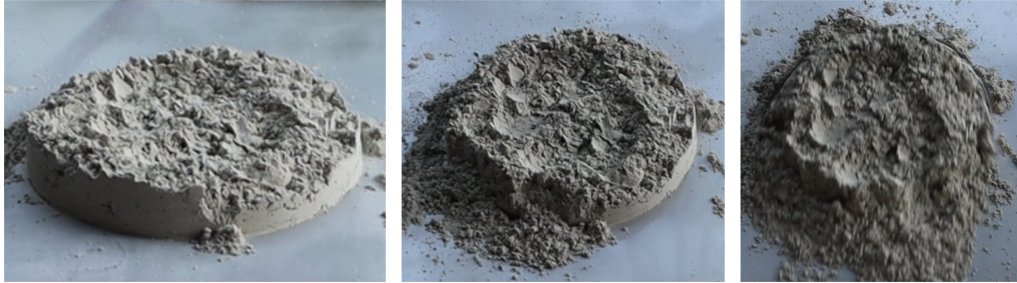
Abbildung 4.6: Probenform in Abhängigkeit des Neigungswinkels der Metallplatte: 0° Neigungswinkel (links), 20° Neigungswinkel (mitte), 36° Neigungswinkel (rechts)
