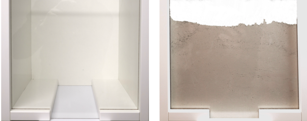
Abbildung 4.2: Versuchsaufbau zur Ermittlung des Ausströmwinkels - unbefüllter Zustand (links) und befüllter Zustand zur Versuchsdurchführung mit vorhandenem Schieberblech (rechts)
