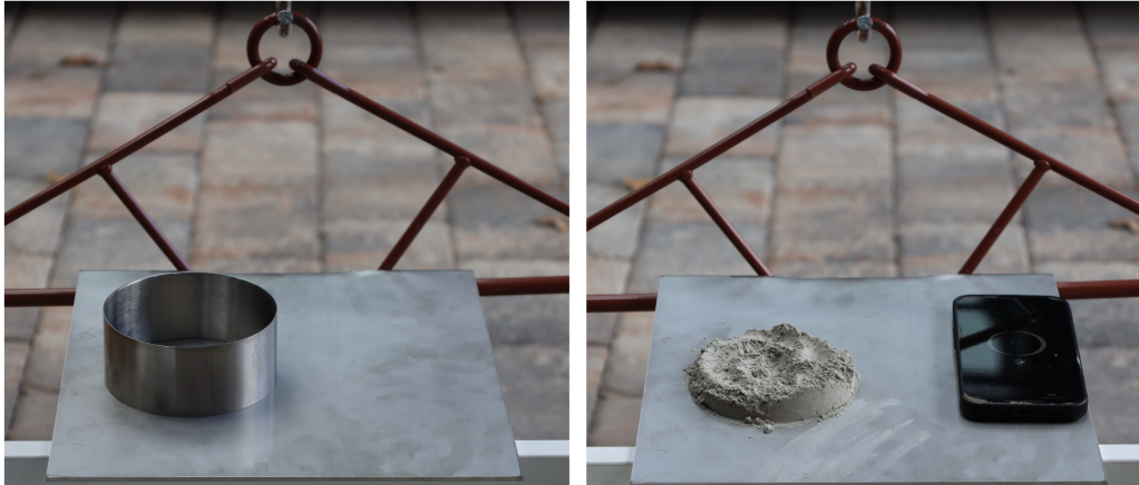
Abbildung 4.3: Versuchsaufbau zur Bestimmung des Reibwinkels von Zement - Probenform ohne Schüttgut bei einem Neigungswinkel von 0^\circ (links) und aufgebraute Probe bei einem Neigungswinkel von 0^\circ (rechts)
