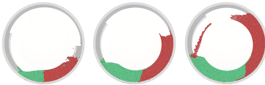
Abbildung 4.25: Partikelbewegung bei steigendem Füllgrad - 20 % Füllgrad (links), 40 % Füllgrad (mitte), 60 % Füllgrad (rechts)
