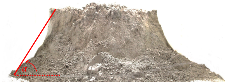
Abbildung 4.4: Schüttwinkel von Zement mit sehr kohäsivem Verhalten nach Versuchsdurchführung
