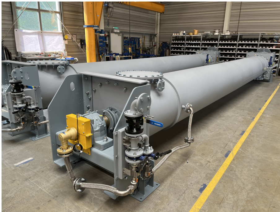
Abbildung 2.3: Kühlrohrschneckenförderer für Bypassstaub ohne Hohlkammerbauweise des Herstellers AMF-Bruns GmbH & Co. KG aus Apen
