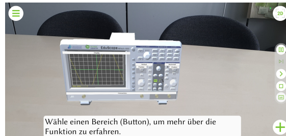
(b) Highlight der Funktionsbereiche und Buttons am Oszilloskop, zu denen Erklärungen vorliegen
