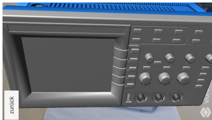
(a) Detailliertes 3D-Modell eines Oszilloskops ohne Textur und Funktion auf einem Bild des Gerätes als Marker (Prototyp: B.0.1.1)
