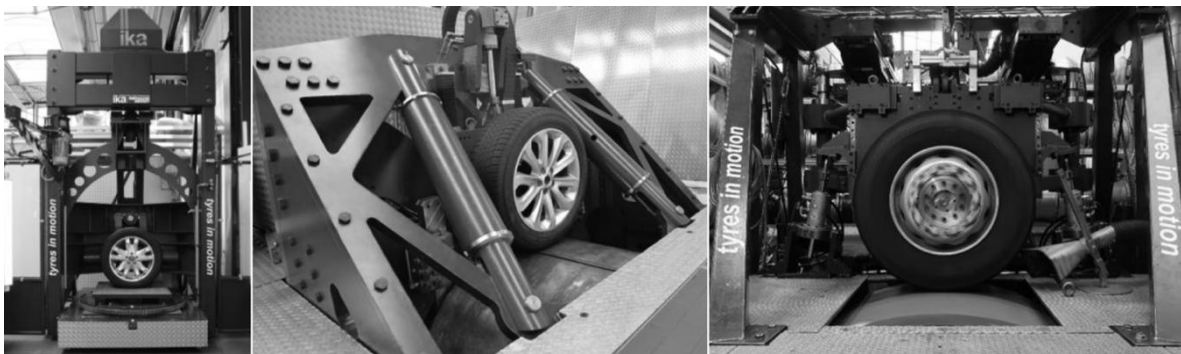
Abbildung 3.43: Zur Parametrierung und Validierung verwendete Reifenprüfstände am fka Aachen [181]
