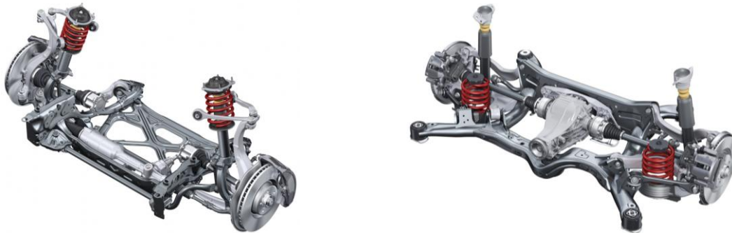
Abbildung 3.1: Vorderachse mit Fünflenker-Radaufhängung (links) und Hinterachse mit Trapezlenker-Radaufhängung (rechts) des Referenzfahrzeugs [124]
