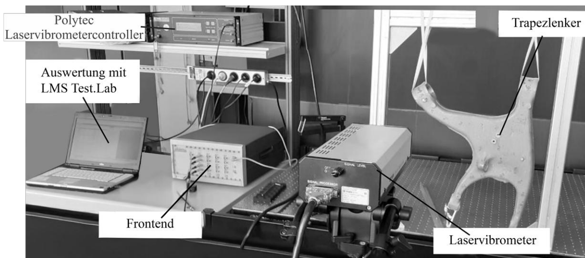
Abbildung 3.10: Messaufbau zu experimenteller Modalanalyse des Trapezlenkers aus der Radaufhängung hinten-links [136]
