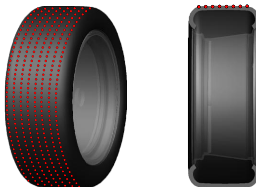
Abbildung 2.16: Exemplarische Darstellung der Verteilung von Kontaktelementen des FTire Kontaktmodells in Linien auf dem Reifenumfang, dargestellt mit acht Umfangslinien [118]
