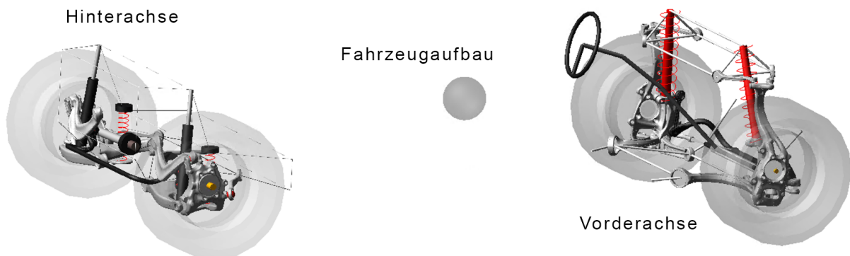
Abbildung 4.1: MKS-Gesamtfahrzeugmodell in ADAMS zur Analyse der Wechselwirkungen zwischen Fahrwerkeigenschaften und Reifenverschleiß [120]
