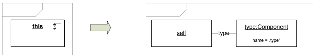
Abbildung 3.37: Übersetzung der this -Komponentenvariable
