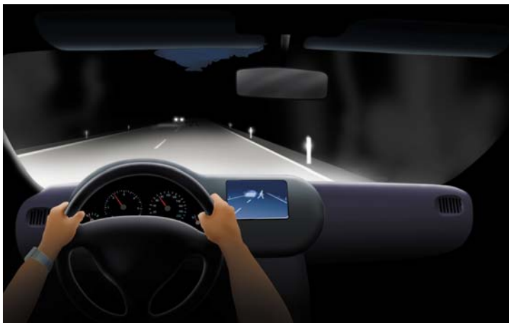
Abb. 2.3: Darbietung des Bildes auf dem Display (Head-down Display) (Hella KGaA Hueck & Co.)
