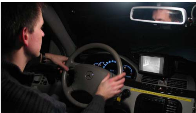
Abb. 5.1: Display des Infrarot-Nachtsichtsystems im Versuchsfahrzeug
