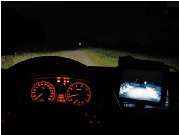
Abb. 5.7: Display des Nachtsichtsystems im Versuchsfahrzeug
