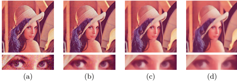
Abbildung 3.14: Anisotroper Skalenraum für das Lena-Bild mit 20% unkorreliertem Rauschen für jedes Pixel des Eingangsbildes: (a) Eingangsbild, (b) c=3 , (c) c=20 und (d) c=250 .
