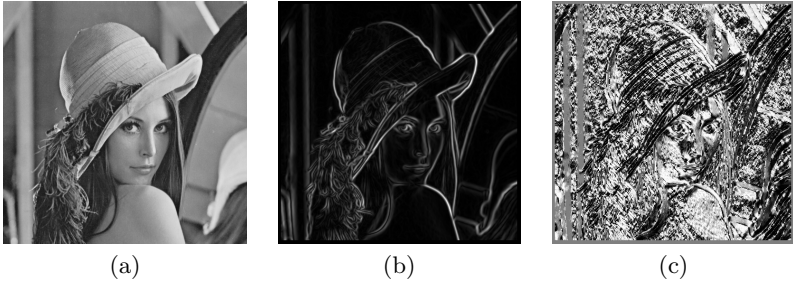
Abbildung 3.4: Ergebnisse der Filterung mit den in Abbildung 3.3 und 3.2(a) dargestellten Kantenfiltern, einem Filterradius von sieben Pixeln und 24 betrachteten Orientierungen. (a) Eingangsbild, (b) Filtermaximum und (c) Winkel der betragsgrößten Filterantworten.
