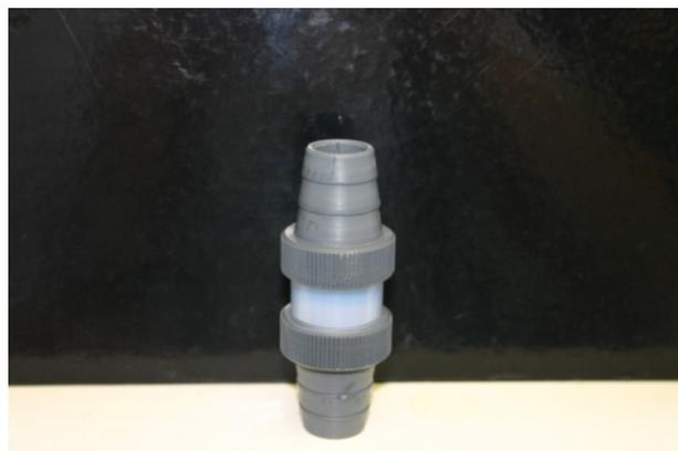
Abb. 70: Mit HMMM Gel gefüllte Doppeldiffusionszelle.
