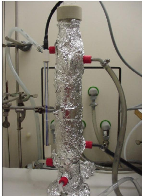
Abbildungen 15a und 15b: UV-Durchflussreaktor zur Entkeimung
