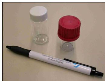
Abbildung 9.9: Verwendete Ansatzgefäße (linkes Gefäß:  $d_{\text{innen}} = 25 \text{ mm}$ ,  $V = 20 \text{ ml}$ ; rechtes Gefäß:  $d_{\text{innen}} = 18 \text{ mm}$ ,  $V = 8 \text{ ml}$ )
