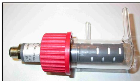
Abbildung 9.3: Messkammer für die Bestimmung der CO<sub>2</sub>-Konzentration incl. des CO<sub>2</sub>-Sensors GMP 221
