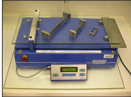
Abbildung 9.10: Beschichtungsgerät Erichsen Coatmaster 509 MC
