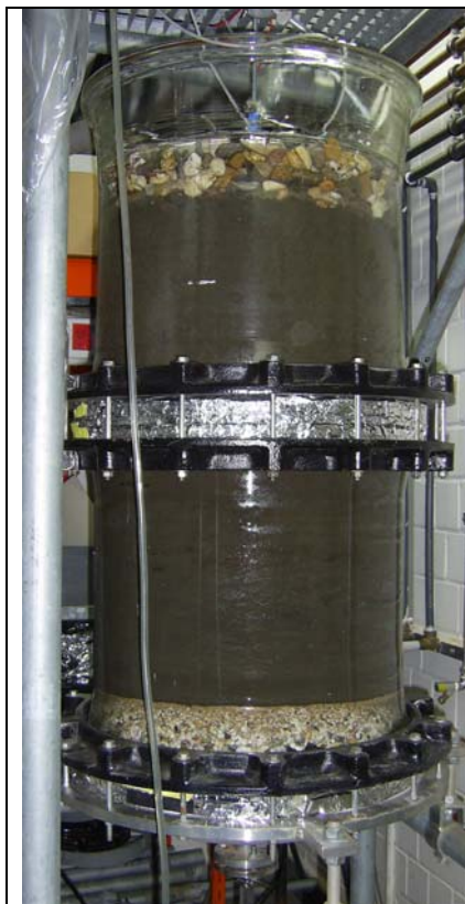
Abb. 54: Bodensäule des halbtechnischen Säulenversuchs (für das Foto wurde die Lichtschutzverkleidung abgenommen) [IfW, 477]
