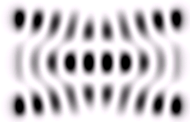
Abbildung 3.8.: Betrag der elektrischen Feldstärke der Überlagerung zweier näherungsweise entarteter Moden nahe dem Cut-Off. Exemplarisches Simulationsergebnis aus Comsol®.
