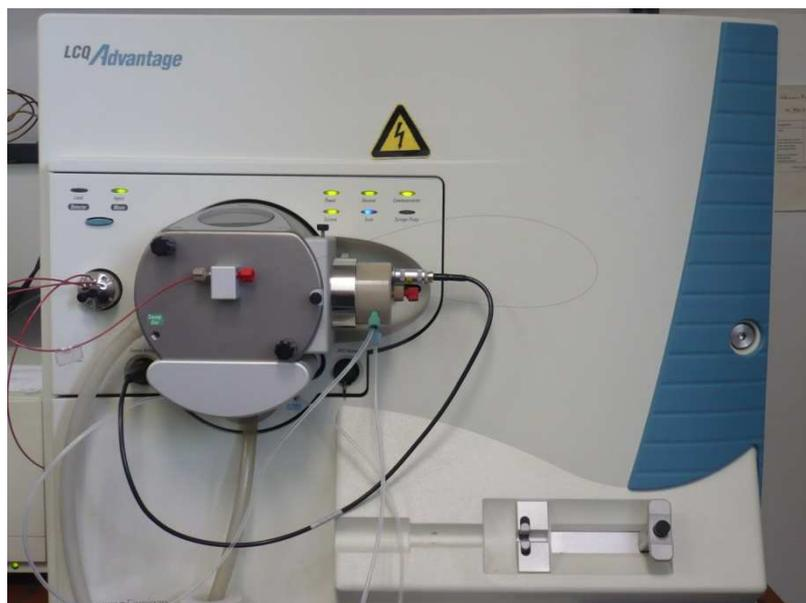
**Abb. 85:** LCQ-Advantage: Dreidimensionale Ionenfalle (Iontrap)
