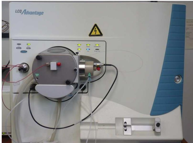
**Abb. 27:** Frontansicht des LCQ-Advantage Massenspektrometers mit ESI-Interface (Fa. Thermo Finnigan)
