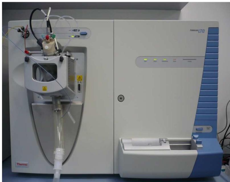
**Abb. 28:** Frontansicht des LTQ-Massenspektrometers mit ESI-Interface (Fa. Thermo Fisher)
