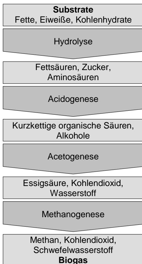
Abbildung 3.1: Ablauf des Biogasprozesses in Anlehnung an [Fac-06b]
