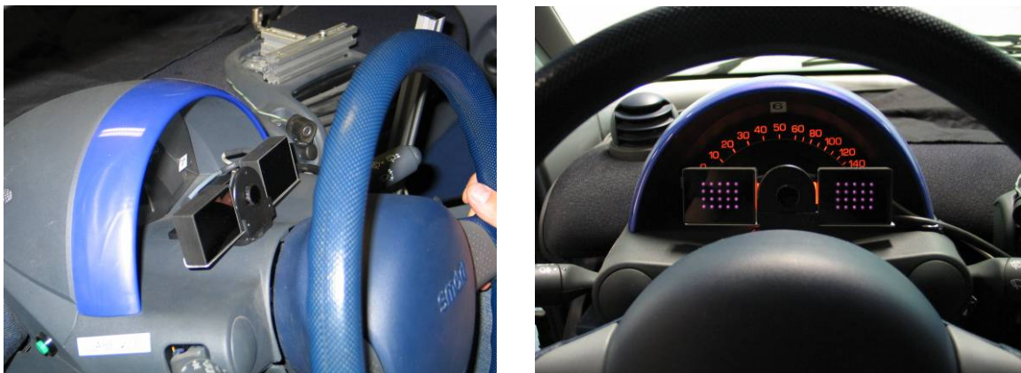
Abb. 5.23: Kamera des Müdigkeitserkennungssystems im Fahrsimulator
