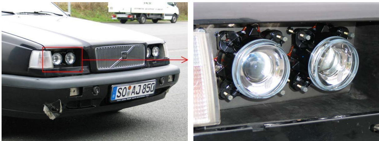
Abb. 5.32: Versuchsfahrzeug mit eingebauten Scheinwerfermodulen
