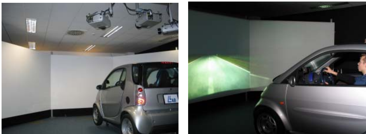
Abb. 5.8: Links: Aufbau des Fahrsimulators Lightdriver. Rechts: Fahrt unter Nachtbedingungen
